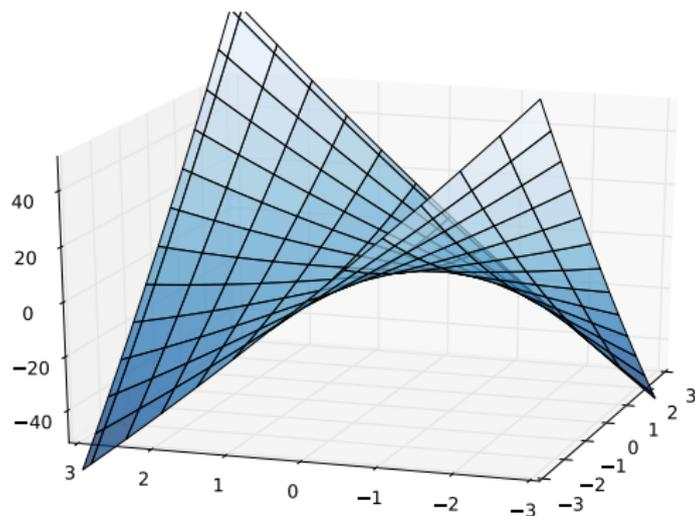
Figure : Indefinite quadratic function  $Q(\mathbf{x}) = x_1^2/2 + 8x_1x_2 + x_2^2/2$
